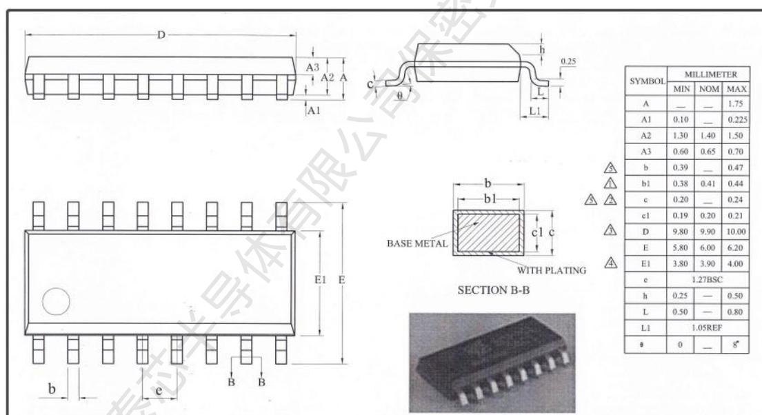
图 1-13 SOP16 封装 POD 图
