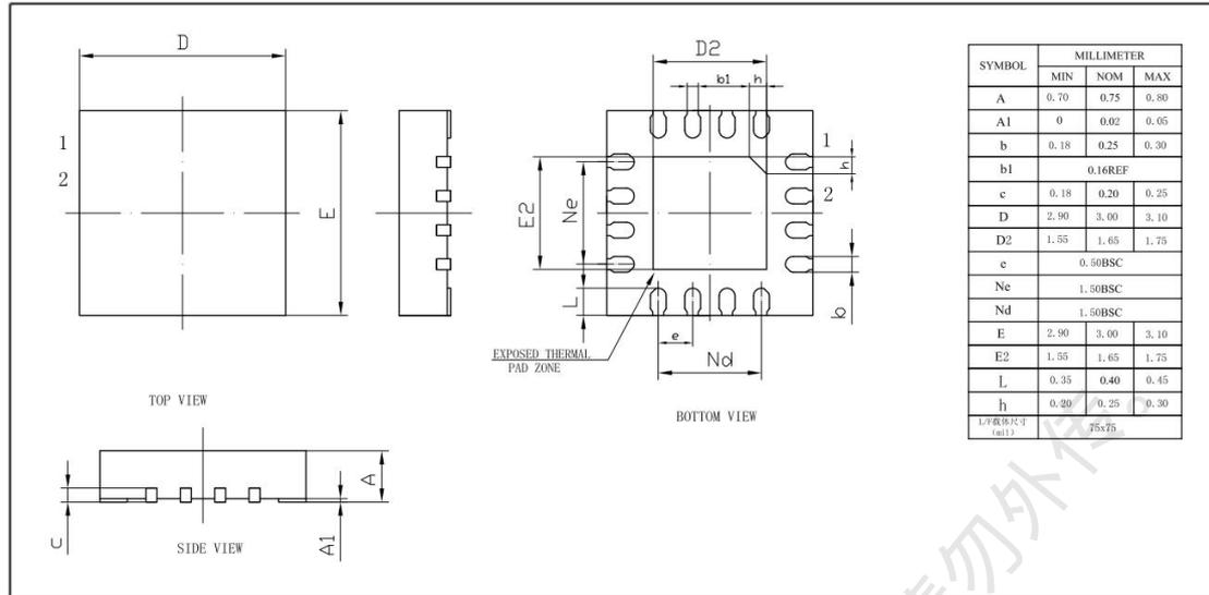
图 1-14 QFN16 封装 POD 图
