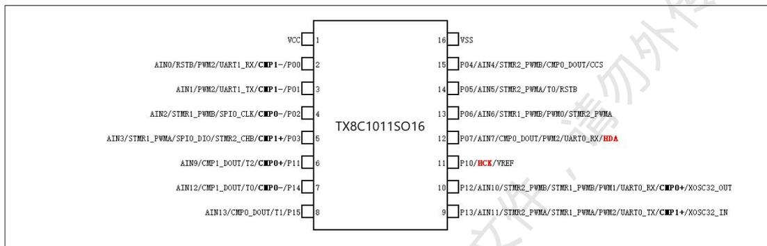
图 1-1 TX8C1011SO16 (SOP16) 引脚图
