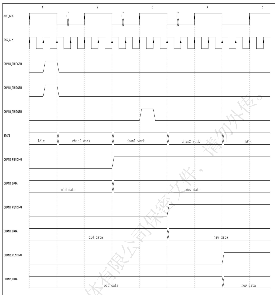
图 20-2 多通道触发模式时序图
