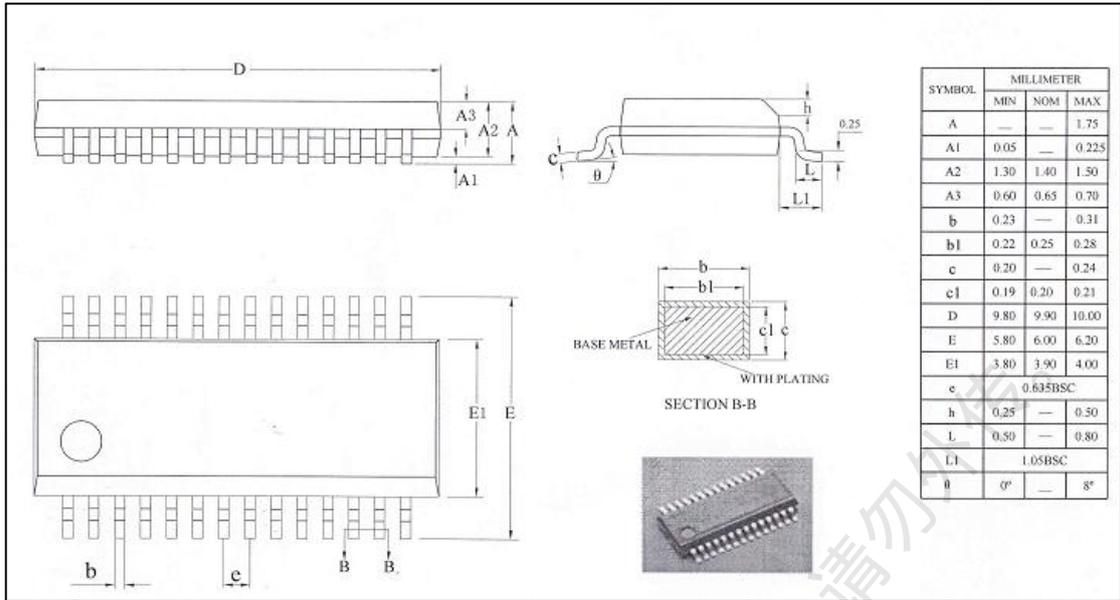
图 14- SSOP28 封装 POD 图
