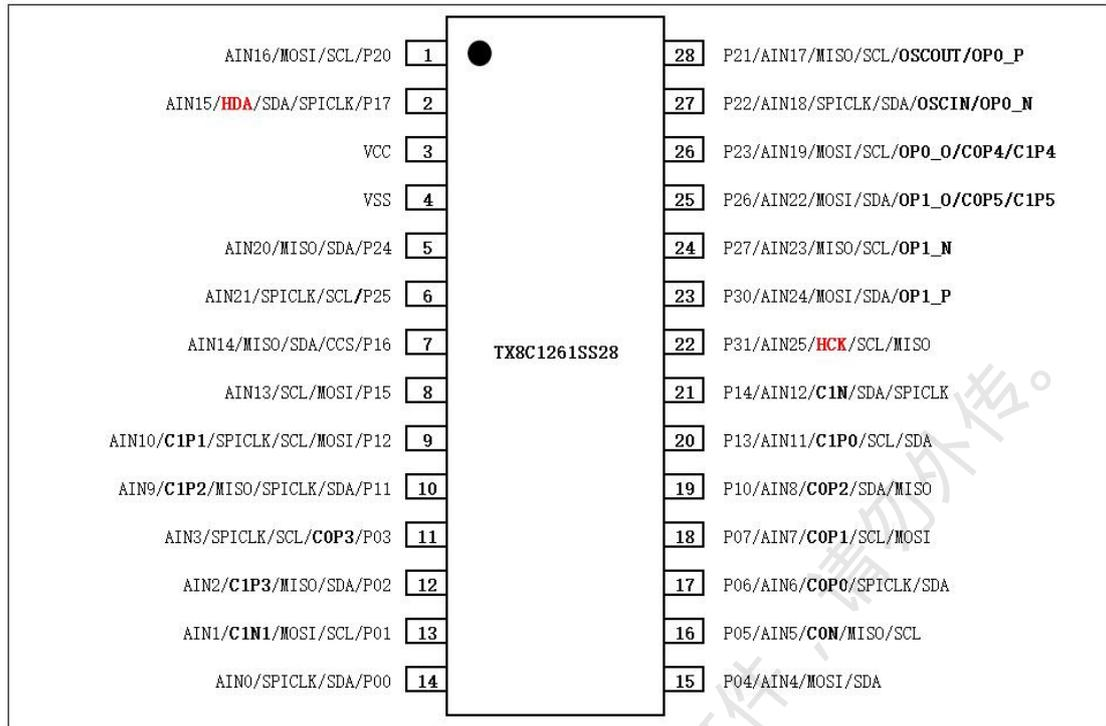
图 7- TX8C1261SS28 (SSOP28) 封装图
