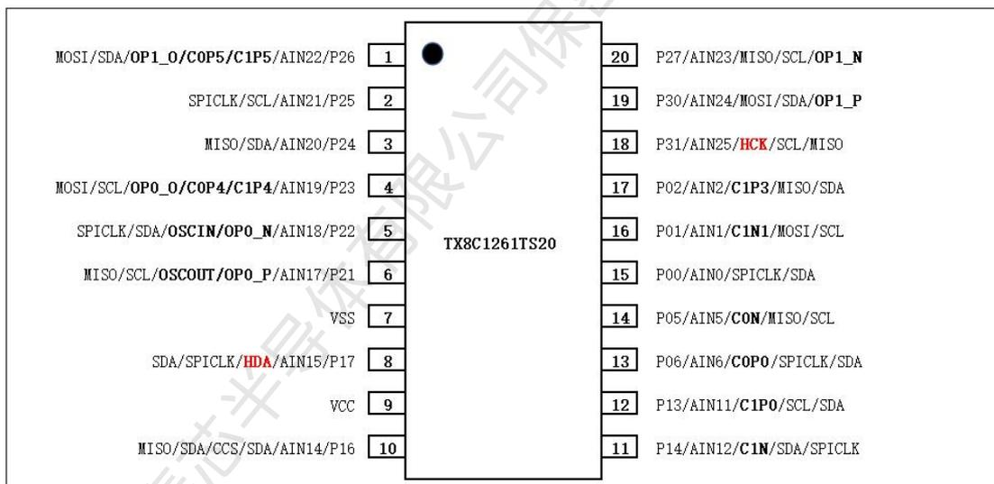
图 2 - TX8C1261TS20 (TSSOP20) 封装图
