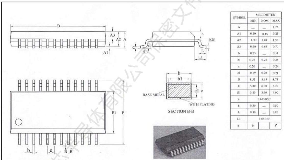
图 11- SSOP24 封装 POD 图
