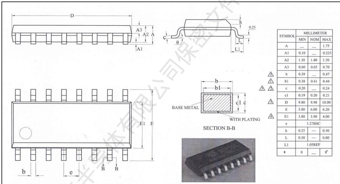
图 15- SOP16 封装 POD 图
