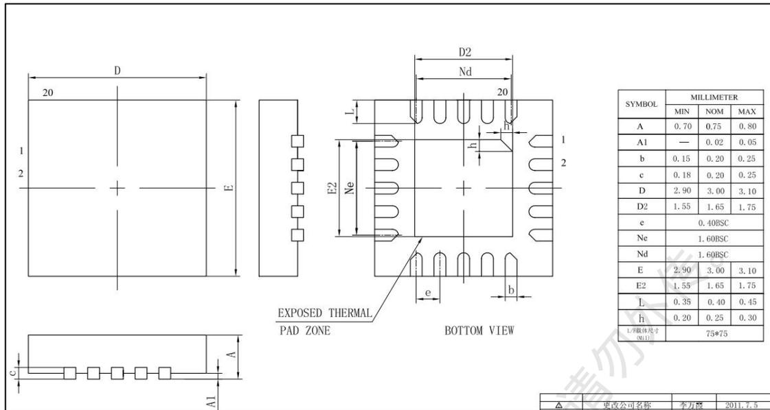
图 12- QFN20 封装 POD 图
