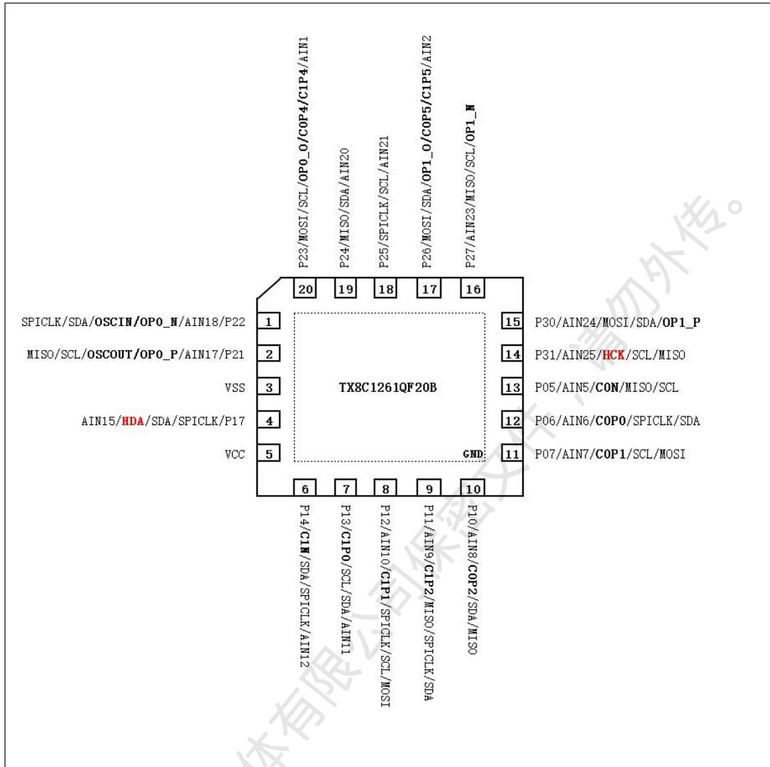
图 5 - TX8C1261QF20B (QFN20) 封装图
