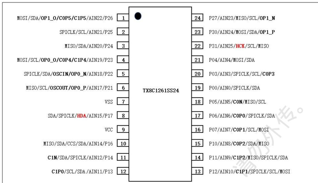
图 3 - TX8C1261SS24 (SSOP24) 封装图
