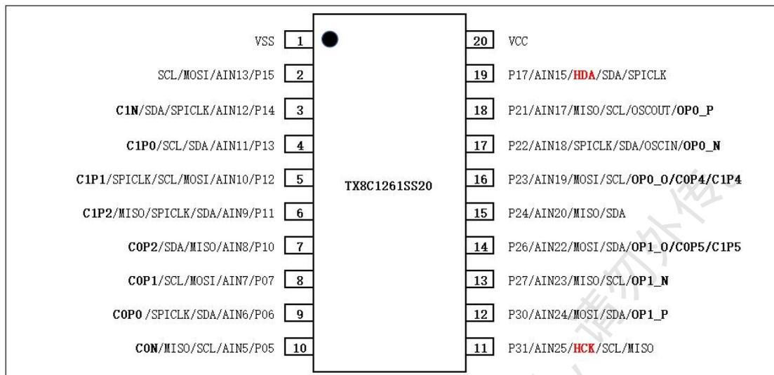
图 1 - TX8C1261SS20 (SSOP20) 封装图
